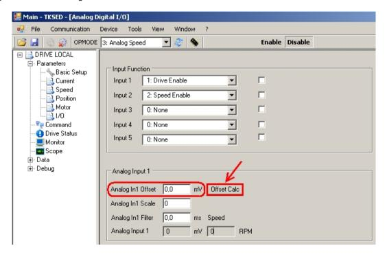
N.B. al termine della procedura di settaggio parametri eseguire *Save* parameters in drive memory per rendere permanenti le modifiche.
