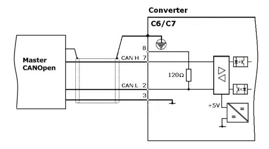
Di seguito un esempio di connessione di un master CANopen con 3 dispositivi collegati.
