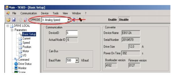
In questa modalità le rampe di accelerazione (Acc. Ramp e Dec. Ramp finestra Speed) sono abilitate. Se si utilizza il dispositivo pilotandolo da un controllo numerico, disabilitare le rampe impostando i parametri "Acc. Ramp" (Default 500ms) e Dec. Ramp" (Default 500ms) al valore 0.
